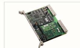
Контроллеры MIF выполнены в крейтовом исполнении формата «Евромеханика – 6U» на базе дублированной последовательной шины CAN-bus.
