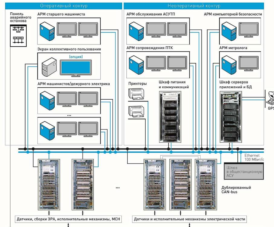
ПТК «Торнадо-М» предназначен для распределённых АСУТП на крупных объектах с высокой степенью ответственности (сотни/тысячи каналов в/в), сложными функциями локального управления. В отличие от «Торнадо-І», имеет следующие особенности:
